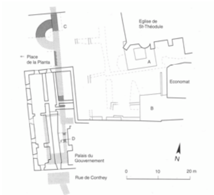
Fig. 25 – Sion, Palais du Gouvernement, aile ouest. Plan de situation d'après Lehner, 1988-90 et TERA Sàrl, 1997-99. A. fondation du clocher de l'église Saint-Théodule; B: caves d'anciens bâtiments; C: enceinte médiévale (parties dégagées en gris foncé, reconstitution de son tracé d'après le plan Schmidt en gris clair); D: emplacement de la coupe stratigraphique illustrée.
